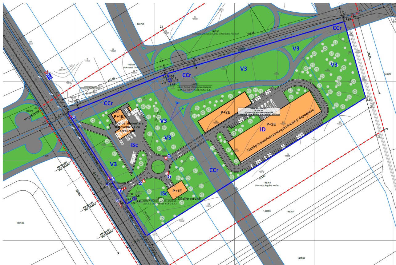
Fig. 3 – Plan amenajare accese din DN1 și circulație interioară pe terenul studiat prin prezentul PUZ
